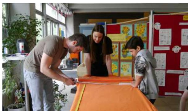
Zwischen den beiden Stoffbahnen (Malerfließ und Baumwollstoff) wurde das Element zur Schalldämmung mit Steinwolle befüllt. Aus Sicherheitsmaßnahmen wurde diese jedoch von den StudentInnen zugeschnitten und in das Panel gelegt.
